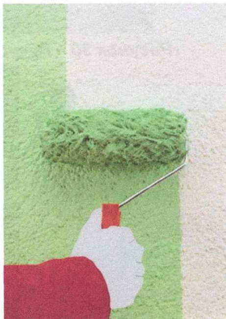
Рисунок 34 – Нанесение окрасочных составов с помощью валика
